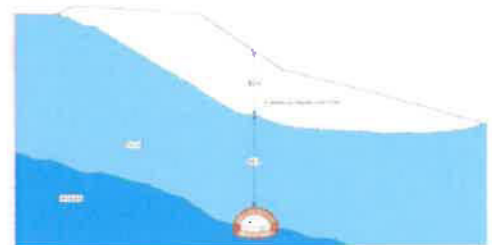
Berechnungsschritt 5, 40% Stützdruck, 60% Vorentlastung
